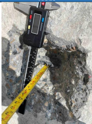
Imagen 223. Registro de recubrimiento cara superior
