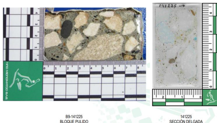
Imagen 305. Bloque semipulido y sección delgada de la muestra ND13
