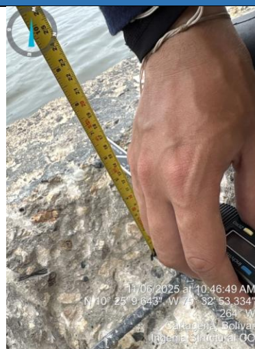
Imagen 198. Registro de recubrimiento cara superior
