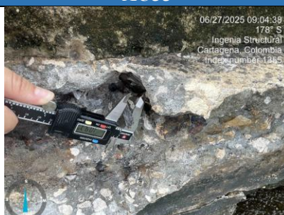
Imagen 217. Registro de recubrimiento cara lateral y diámetro de barra
