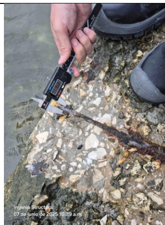
Imagen 173. Registro de diámetro de barra 0-V-CL
