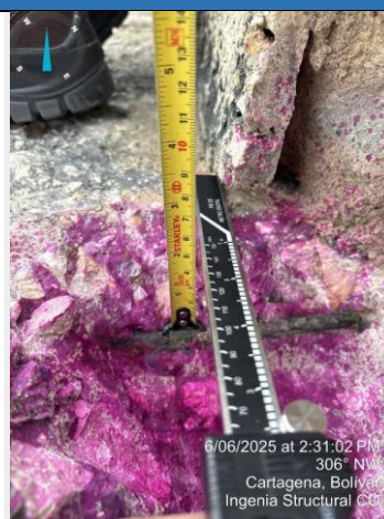
Imagen 164. Registro de recubrimiento cara superior
