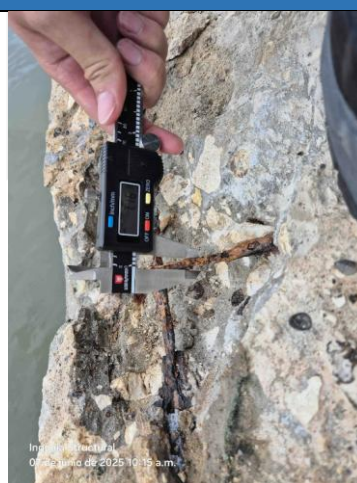
Imagen 160. Registro de recubrimiento y diámetro de barra cara superior
