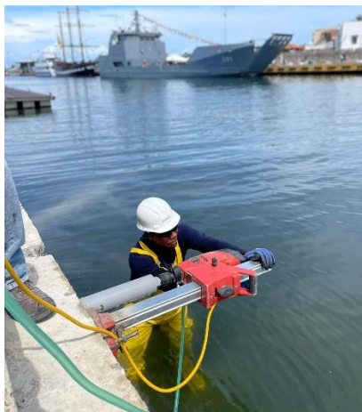
Imagen 27. Extracción de núcleos en cara lateral de la viga, sector 2
