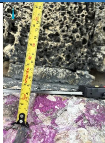
Imagen 166. Registro de recubrimiento cara superior
