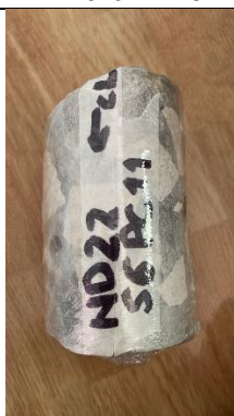
Imagen 112. Núcleo extraído ND622- PC11
