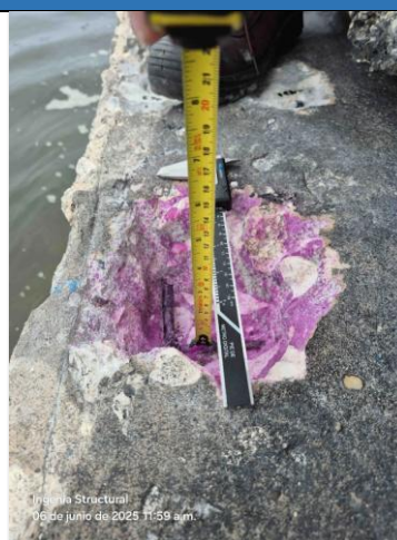
Imagen 158. Registro de recubrimiento cara superior
