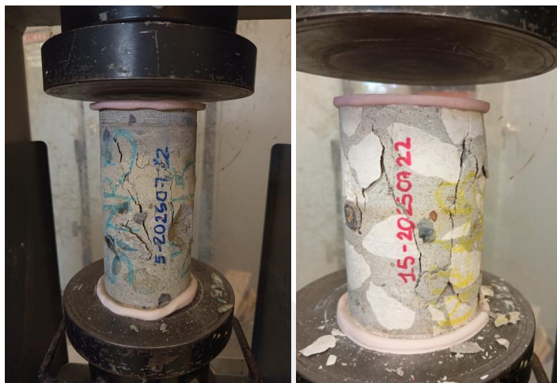
Imagen 289. Testeo de especímenes en maquina universal para ensayos a resistencia a compresión A continuación, en la Tabla 25 se presentan los parámetros básicos de algunos núcleos ensayados, que servirán de insumo para parámetros de durabilidad por cloruros (ver ANEXOS para la totalidad de la información de los núcleos ensayados)
