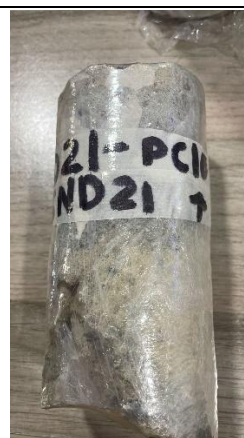
Imagen 111. Núcleo extraído NR621- OC10
