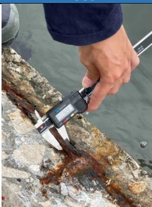
Imagen 199. Registro de recubrimiento y diámetro de barra
