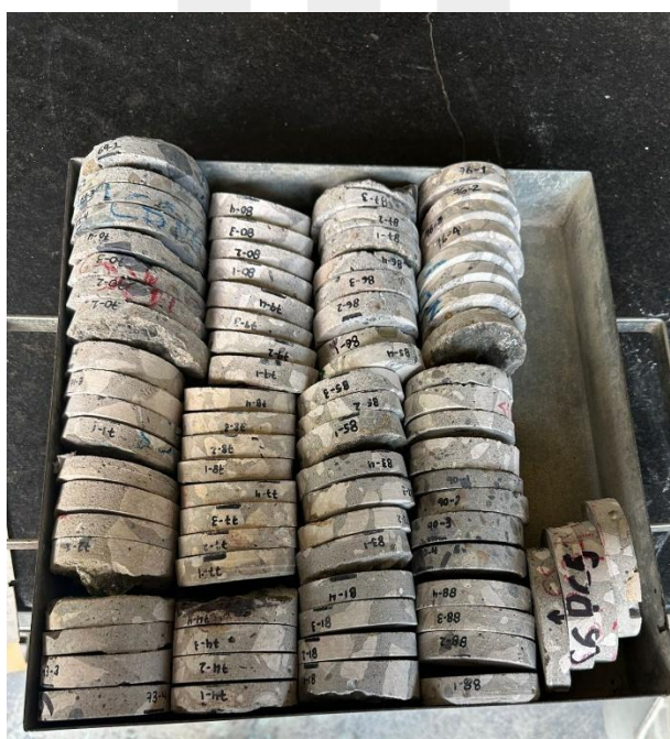
Imagen 291. Cortes de rodajas en muestras de cloruros
