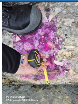
Imagen 176. Registro de recubrimiento cara lateral 50-V-CL
